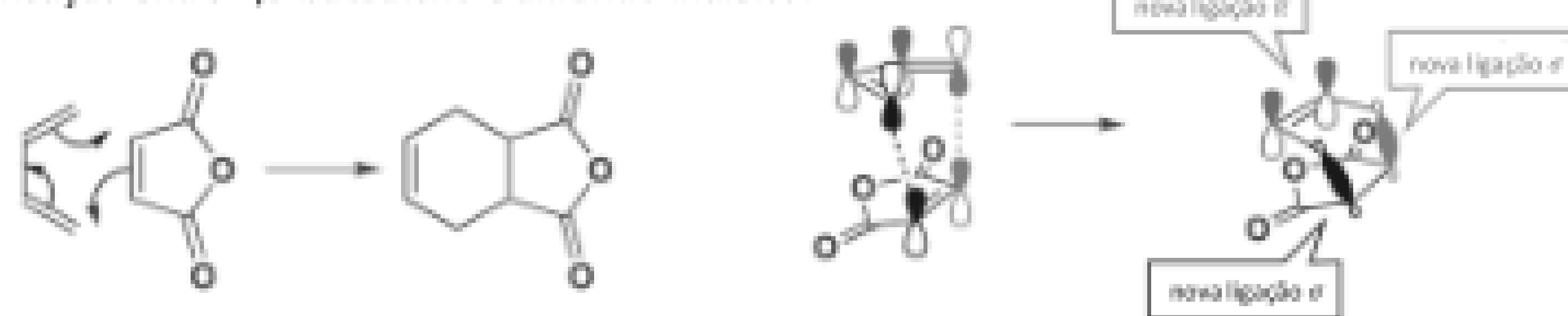
Figura 1. Reação entre 1,3-butadieno e anidrido maleico.
